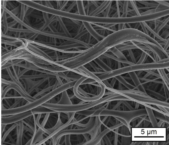
**Abb. 2 Mikrostruktur eines Tropoelastin-Vlieses, das mit Formaldehyd vernetzt worden ist (Aufnahme im Rasterelektronenmikroskop).**
